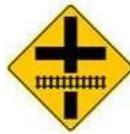
Intersección vial próxima a cruce con vía férrea
