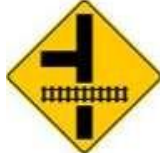
Intersección vial en T próxima a cruce con vía férrea.
