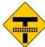
Intersección vial en T secundaria próxima a cruce con vía férrea.
