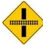
Cruce con vía férrea
